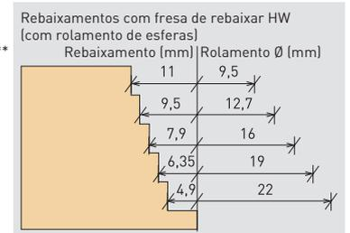
\*\*\* Âmbito de fornecimento: 1 rolamento de esferas de Ø 12,7 mm com rebaixamento de 9,5 mm
