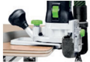
Especialmente para a fresagem de ranhuras para arestas nervuradas, encontra na página 243 um abrangente programa de fresas de entalhes para vidros. Para esta aplicação, é necessário o fuso da fresa.
