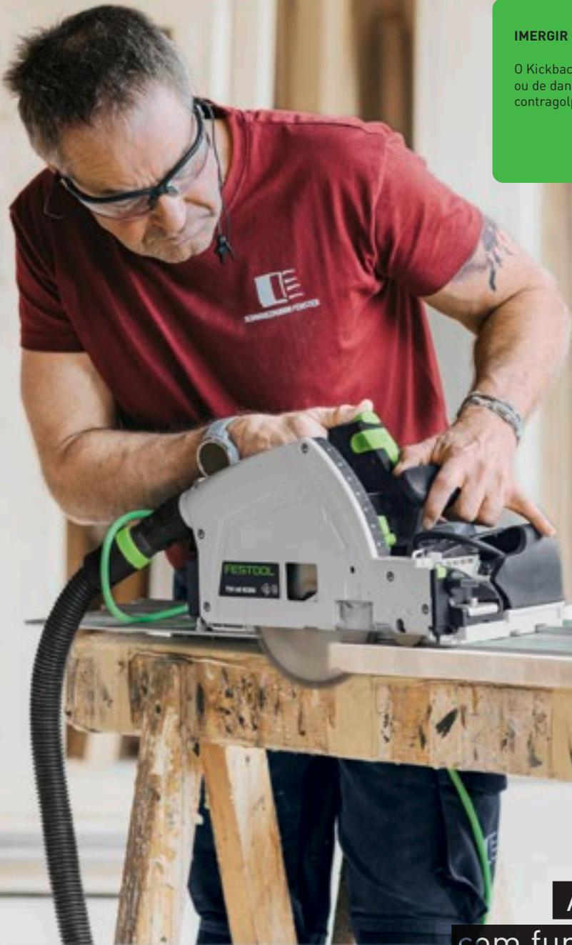
A serra de incisão com função de pré-corte, TSV 60 K, da Festool demarca um posicionamento claro, tanto no recorte de madeira como em materiais modernos. O resultado: cortes sem aparas num só passo.
